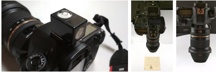
Aparat cyfrowy z zamocowaną poziomą fotograficzną (po lewej); aparat zamocowany na statywie kolumnowym (po prawej) (zdj. K. Zgliński)
